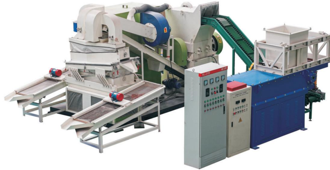
干式铜米机是专业干式分离废旧电线电缆的生产线。例如：旧汽车电路线，通讯电缆线，以及剥线机不适合加工（各种民用电线）废旧杂料电线、毛丝细线等。此机的特点是大小线不用分类可以同时破碎分离，结构新型、独特，生产量大，耗电少。分选率高，一次投料，多机协作完成。全线由PLC控制，在国内处于领先水平。该机的开发成功，即解决了焚烧取铜方法中出现的问题，又能提高回收铜的质量，并可将塑料回收利用，同时解决环境的污染。
