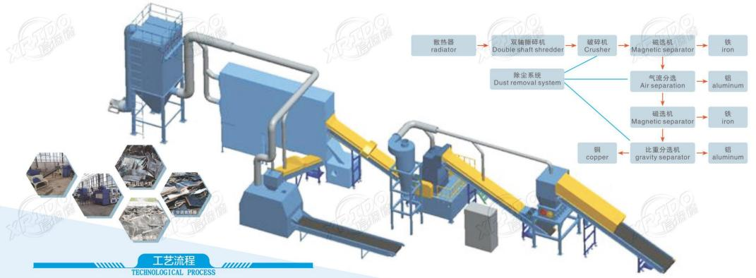
废散热器先经输送机送入双轴撕碎机进行初级破碎,双轴撕碎机将散热器挤压、撕裂,破碎成小块,然后再经输送机送入立式破碎机中进行二次破碎,锤式破碎机将散热器碎片充分解离,并挤压、揉搓成高密度的球团状,破碎后的小颗粒由磁选机将物料中的铁分选出来,剩余的铜和铝进入比重分选机,进行精细分选,分选出剩余的铜和铝。
